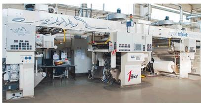
Per quanto riguarda la trasformazione, per le operazioni di laminazione nel 2017 sono arrivate due SUPER COMBI 4000 portando a 4, assieme alle due già presenti
